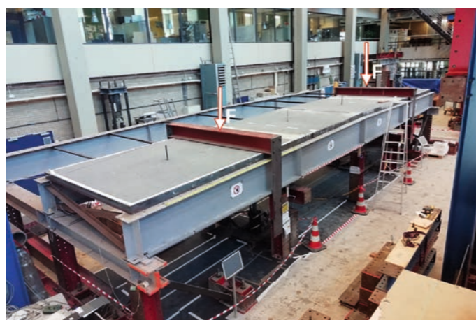
5b. Testopstelling met twee taps toelopende stalen liggers, twee prefab betonnen vloerelementen en demontabele afschuifverbindingmiddelen. Een tweetal puntlasten F wordt symmetrisch aangebracht op 4,05 m vanaf de opleggingen.
