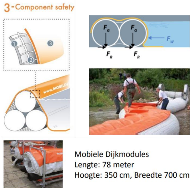
Figure 5 Schematisation of Mobile Dikes (Mobiële Dijken, 2016)
