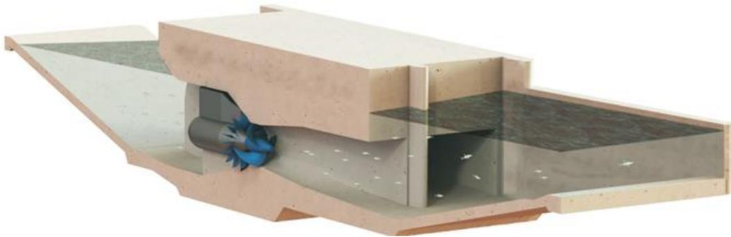
Figure 26: horizontal turbine ("Lagedruk Waterturbine", 2020)
