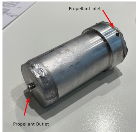
(d) RAC pieces welded together
